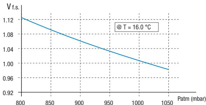
**Variazione della velocità di fondo scala con la pressione barometrica a temperatura costante**
