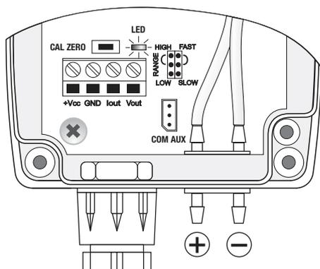
Tasto di CAL ZERO e ponticelli di configurazione
