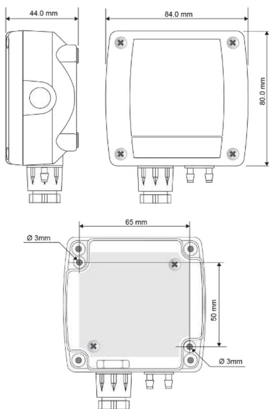
HD404T può essere montato in qualsiasi posizione, ma tipicamente su una parete verticale con le prese di pressione rivolte verso il basso. Lo scostamento dello zero dovuto alla posizione di montaggio può essere corretto utilizzando il tasto CAL ZERO. La procedura da seguire per la calibrazione manuale dello zero è la seguente:
