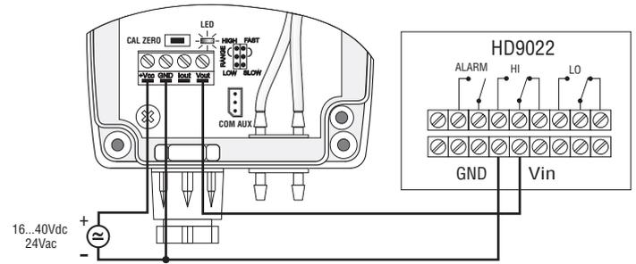
Uscita in tensione 0...10Vdc
