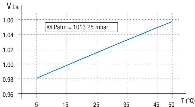
**Variazione della velocità di fondo scala con la temperatura a pressione barometrica costante**
